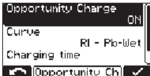
per prolungare l'intervallo di funzionamento della batteria è possibile, ad esempio durante una pausa di funzionamento, ricaricare la batteria.
