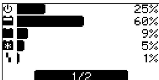
Nella modalità statistica, le barre orizzontali visualizzano la frequenza degli stati di funzionamento dell'apparecchio indicati di seguito:
