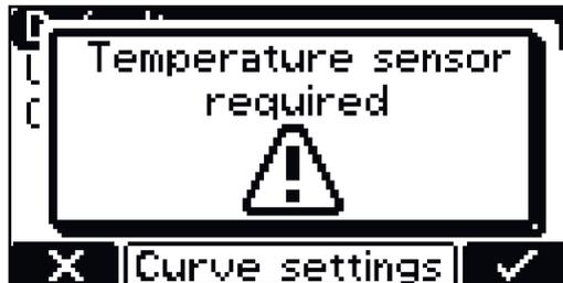
Se viene selezionata una curva caratteristica che richiede un sensore di temperatura esterno, compare un avviso.
