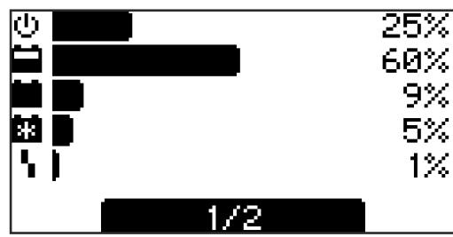
U statističkom načinu rada horizontalne crte vizualno predviđaju učestalost sljedećih radnih stanja uređaja:
