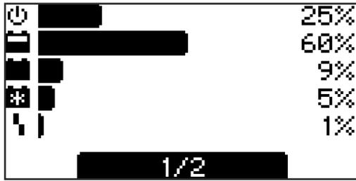
Nella modalità statistica, le barre orizzontali visualizzano la frequenza degli stati di funzionamento dell'apparecchio indicati di seguito:
