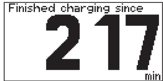
L'icona della batteria serve per indicare lo stato di carica attuale. Il numero di tacche visualizzate aumenta con l'avanzare del processo di carica. Non appena la batteria è completamente carica, viene visualizzato un contaminuti (figura a destra), che tiene il conto dei minuti trascorsi dal termine della carica e aiuta a valutare più facilmente le batterie già completamente raffreddate quando si utilizzano più caricabatterie.
