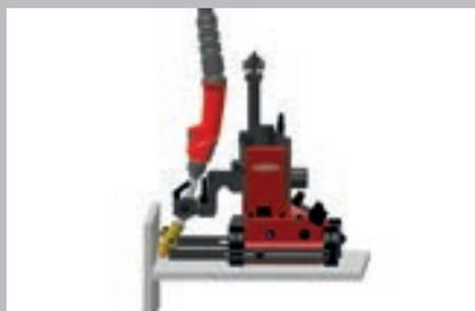
/ Soldadura en ángulo en componentes horizontales
