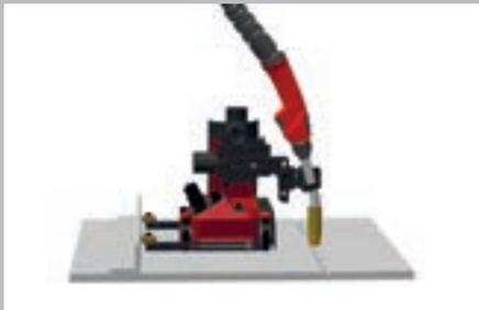
/ Soldadura a tope en componentes horizontales
