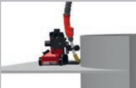
/ Soldadura en ángulo en componentes convexos
