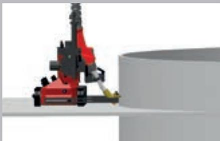
/ Soldadura en ángulo en componentes convexos
