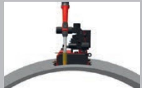
/ Soldadura a tope en componentes convexos
