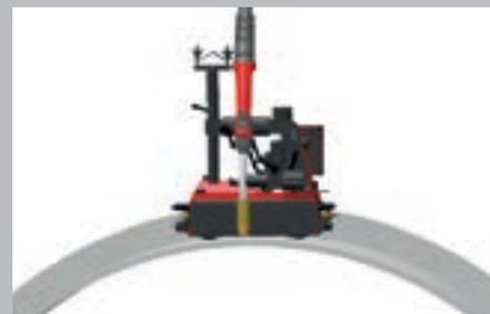
/ Soldadura a tope en componentes convexos
