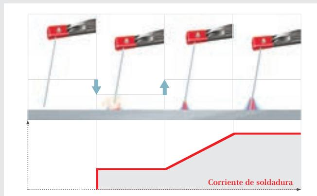
/ Arco voltaico estable gracias a Softstart para electrodos alcalinos que se encienden con una baja corriente de soldadura.
