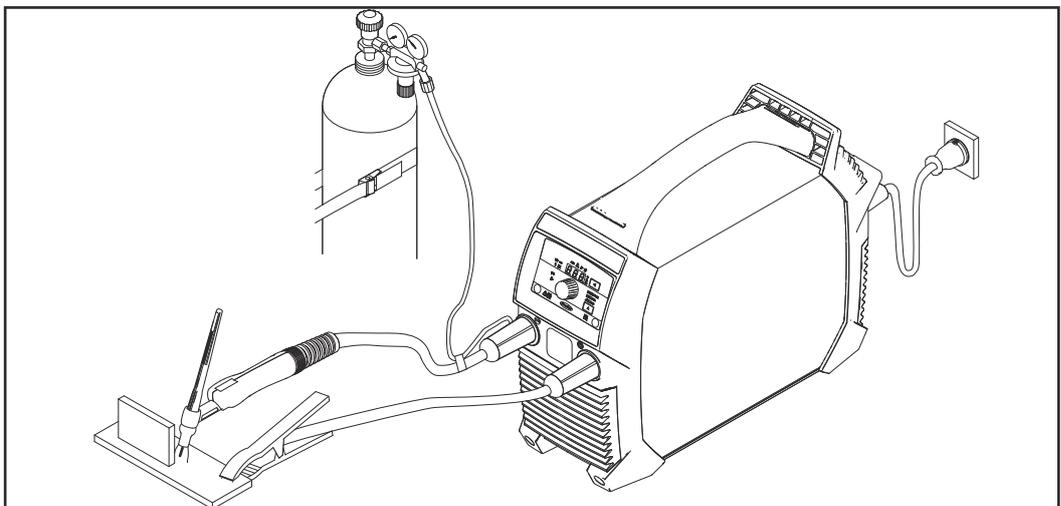
WIG-Schweißen, Schweißbrenner mit Gas-Absperrventil
