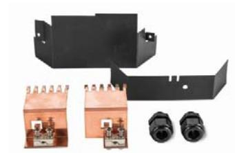
/ Das DC Con Kit ermöglicht das Bügeln der beiden Eingänge bei MPP-Strömen über 35 A und einem Kabelquerschnitt über 16 mm<sup>2</sup>, zum Beispiel bei Verwendung einer DC Box. Mit dem DC Con Kit 35 sind Querschnitte bis 35 mm<sup>2</sup> möglich, damit kann eine größtmögliche Distanz zwischen Wechselrichter und Modulen erreicht werden. Die Klemme ist berührsicher aufgebaut. Das DC Connector Kit eignet sich speziell zur Verwendung mit Fronius Symo 10.0 – 20.0 kW und Fronius Eco Wechselrichtern.
