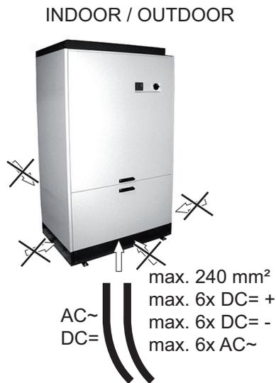
AC-Kabel, DC-Kabel, Kabel für die externe Versorgung des Wechselrichters und gegebenenfalls Datenkommunikations-Kabel müssen von unten in den Wechselrichter zugeführt werden (z.B. über einen Kabelschacht oder einen doppelten Boden).
