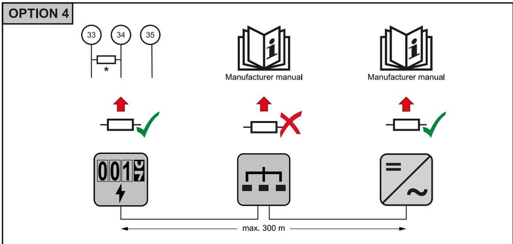
\* In Fronius Smart Meter la resistenza terminale viene stabilita tra "33" e "34". La resistenza terminale R 120 Ohm è inclusa con Fronius Smart Meter.
