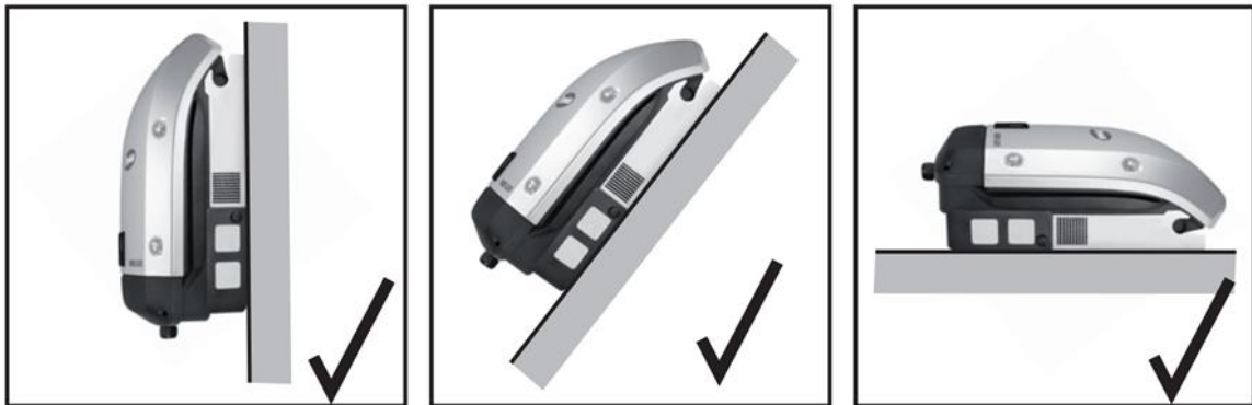
Abbildung 2: Flexible Befestigungsmöglichkeiten von aktiv gekühlten Fronius Wechselrichtern [Quelle: Fronius]
