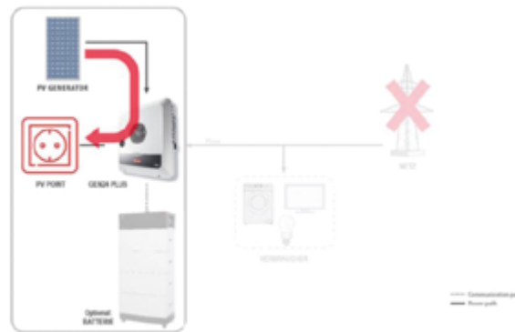
Rysunek 1: Schemat podstawowej funkcji zasilania awaryjnego (PV Point) urządzenia Fronius GEN24 Plus
