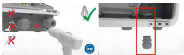
Rysunek 3: Nawiercenie falownika i umieszczenie dławika przewodowego PG w modyfikowanym obszarze.
