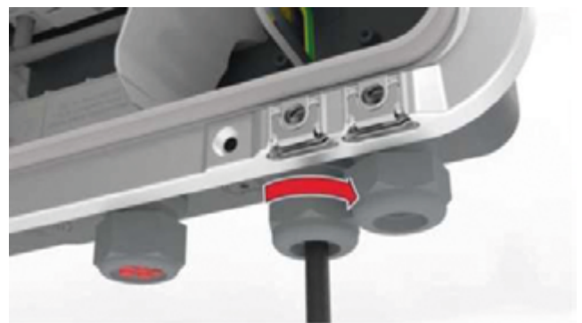
Rysunek 7: Połączenie śrubowe wlotu go
