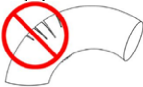
Ryc. 8: Należy nie doprowadzać do pęknięcia izolacji
